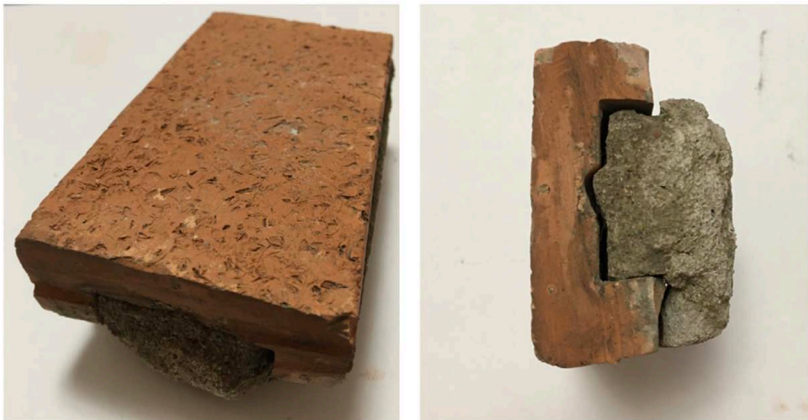
Particolare delle finitura superficiale e della sezione del listello di laterizio originale
