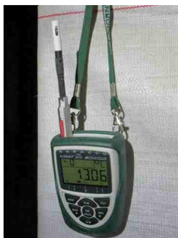
Datalogger con sonda termoigrometrica ALMEMO FHAD46
